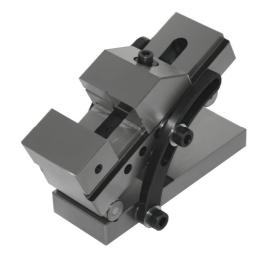
Тиски, сочетающие в себе, удобство и функционал уже рассмотренных нами тисков лекальных типа 3340 и типа 3350 и являются одновременно синусными лекальными и быстропереналаживаемыми. Само собой, точность таких тисков также соответствуем критериям прецизионных тисков и составляет 0,0005 мм на 100мм имея закаленные и шлифованные направляющие с твердостью HRC 58-62 и такие же губки.
