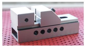
это тиски позволяющие выполнять быструю установку деталей различных размеров без необходимости вращать рукоятку зажима на все длину хода губки. Подвижная губка имеет свободной ход вдоль направляющей и для того чтобы установить деталь достаточно передвинуть губку на ближайший к зажимаемой детали паз и вставить
